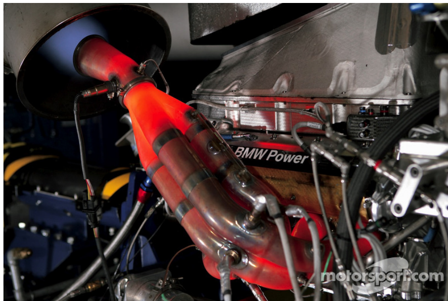
Figura 7: Motor BMW da equipe Sauber em teste de potência, temporada de 2006.
