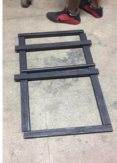
Figura 39: Registro fotográfico do posicionamento dos tubos da mesa horizontal
