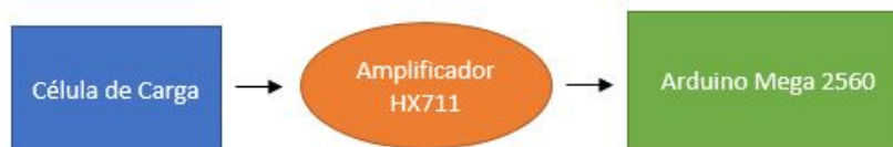
Figura 36: Esquemático da ligação da célula de carga com o HX711 e o Arduino
