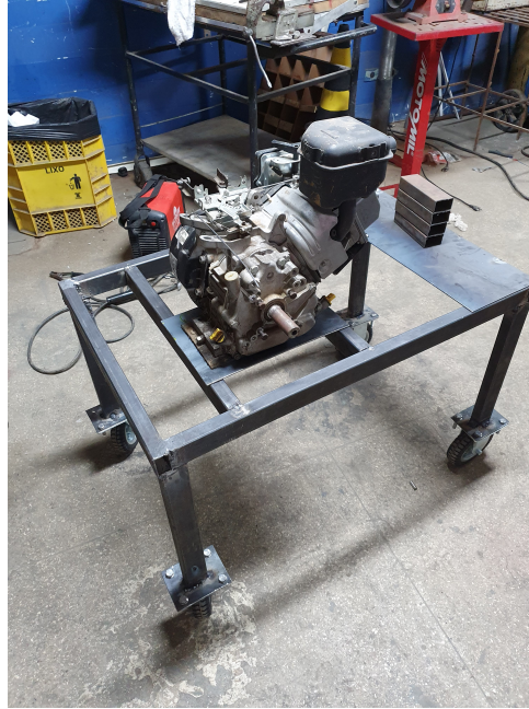
Figura 42: Posicionamento do motor do Baja na bancada de testes
