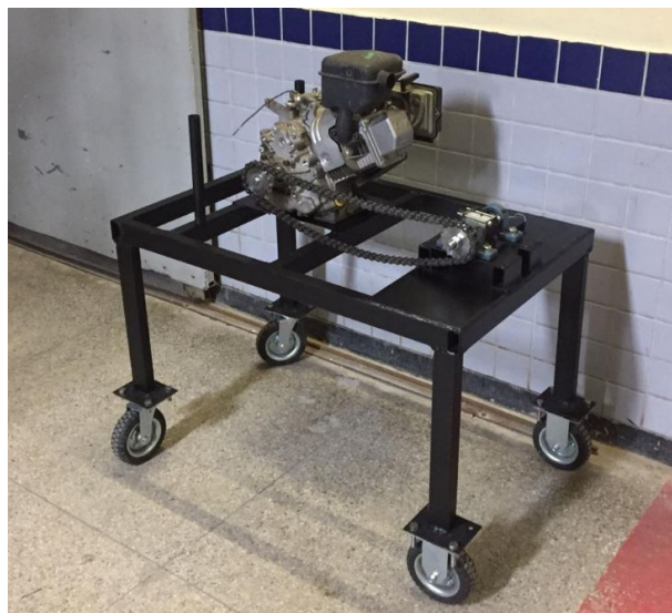
Figura 18: Motor Briggs & Stratton 10Hp montado na bancada
